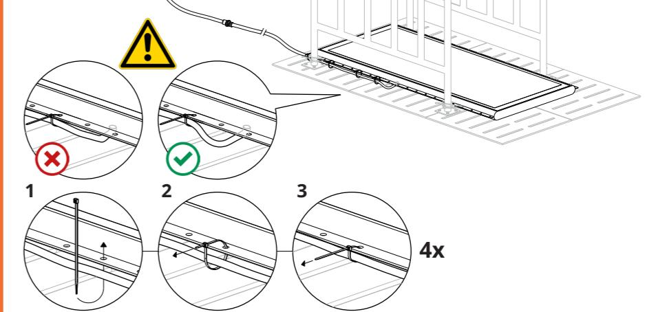
**6** Colocar el exceso de manguera fuera del alcance de las vacas. Asegurar firmemente la manguera al tubo redondo con al menos 2 bridas para evitar que se mueva. Asegúrese de que la manguera hace un buen bucle.
