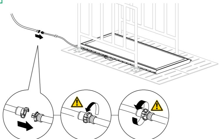
**5** Asegurar la manguera a la alfombra con al menos 4 bridas para evitar que se mueva. ⚠ Asegurarse de que la manguera sale de la alfombra formando un buen círculo. No fijar la manguera demasiado apretada en una dirección a la salida de la esterilla para evitar fugas. Retirar el exceso de bridas y mantenerlas en su sitio.
