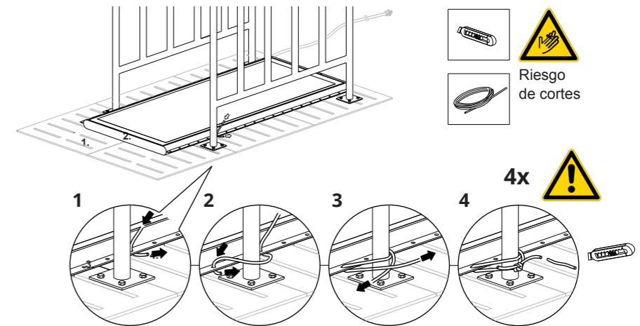
**3A** Opcional: Fijar la alfombra en 2 puntos con anclajes AHC en el hormigón. Colocar la placa inferior en el suelo y pretaladrar los agujeros en el hormigón. Colocar las lengüetas de la placa superior en los orificios redondos de la alfombra. Fijar la placa superior a la placa inferior con tornillos M12.
