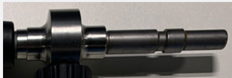
På billedet vises en KEW-kobling. Denne kan spændes med en unbrakonøgle.
