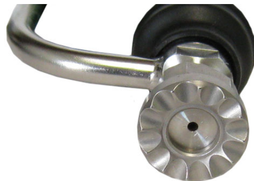
Buse mise devant derrière pour nettoyage
