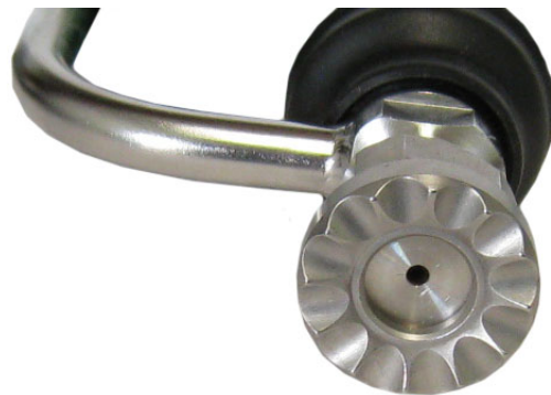
Düse zur Reinigung anders herum eingesetzt
