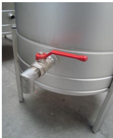
Uitloop aan de onderzijde van de tank.
