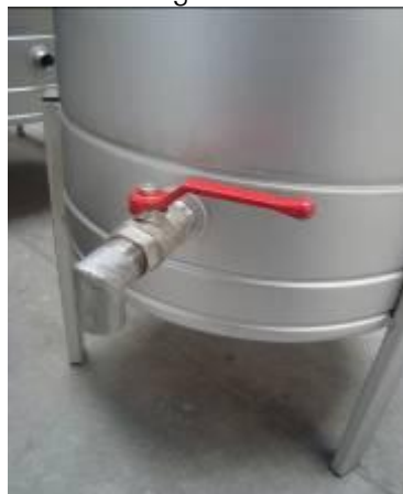
Photo. Laisser l'eau se déverser en dessous de la cuve.
