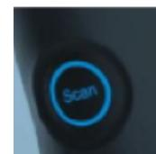
Presione el botón principal y sosténgalo durante 7 segundos. Una luz empieza a parpadear. La sonda buscará automáticamente una señal WIFI que funcione.
