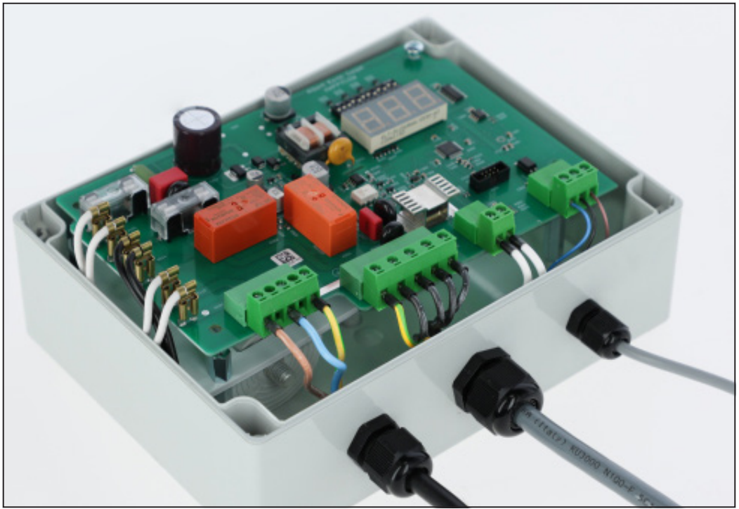
Abbildung 9: Platine in Steuerungsgehäuse (Kondensator hinter der Platine)
