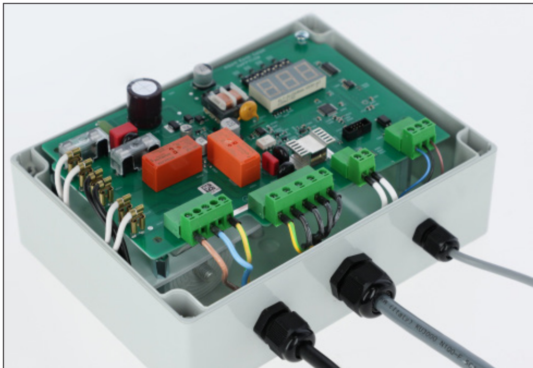
Bild 9: Kretskort i styrsystemhöljet (kondensator bakom kretskortet)
