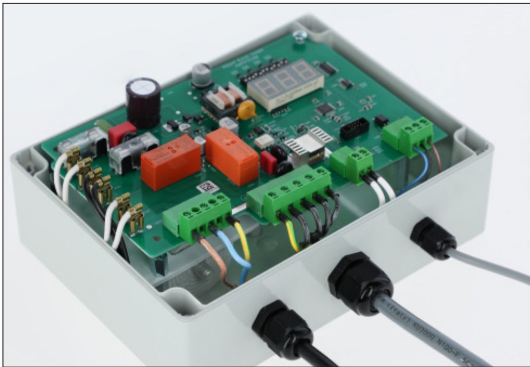
Kuva 9: Piirilevy ohjausyksikön kotelossa (kondensaattori piirilevyn takana)
