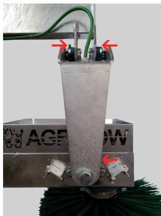
Brosse pendulaire - points de lubrification
