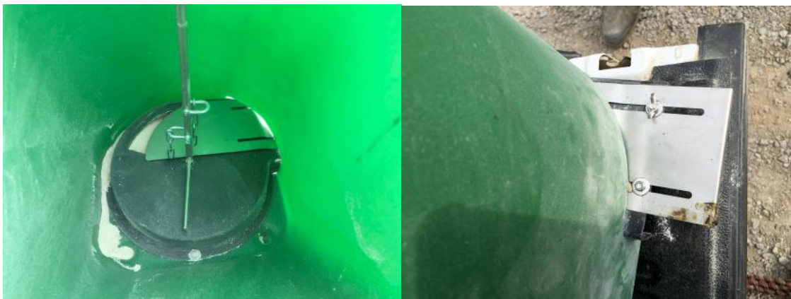
Der Dosierschieber auf dem MS-Spreader montiert
