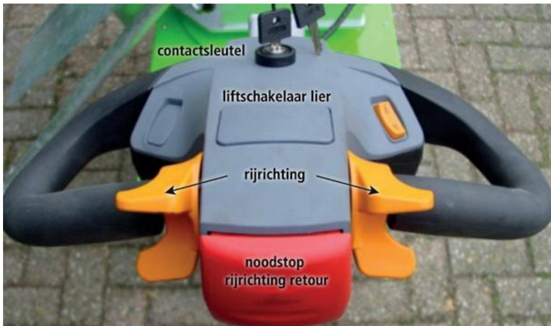
Bedienkonsole (Originalabbildung). Übersetzte Beschriftungen: Kontaktschlüssel - Hub-/Windenschalter - Fahrtrichtung - Not-Halt/Fahrtrichtung zurück.
