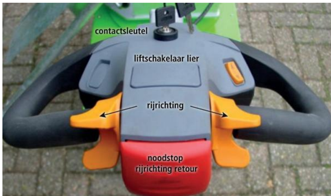
Pannello comandi (illustrazione originale). Traduzione delle diciture: chiave di contatto - interruttore sollevamento/verricello - direzione di marcia - arresto di emergenza/ritorno direzione di marcia.
