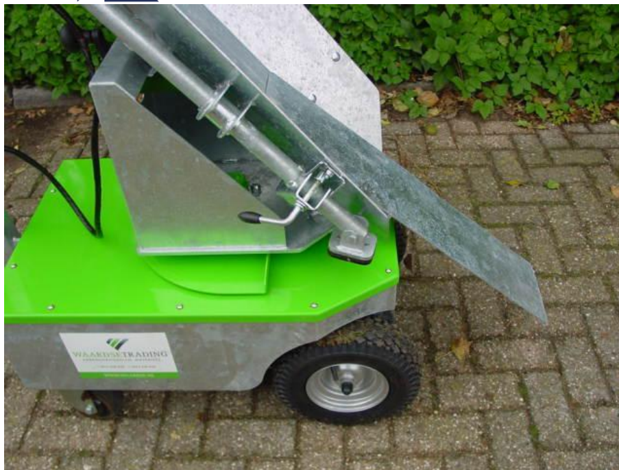
Zona di introduzione/scorrimiento della canaletta per carcasse (illustrazione originale).
