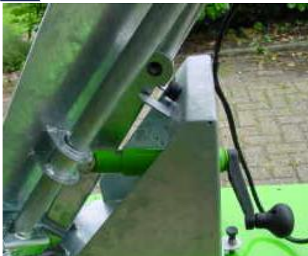
Illustrazione originale: bloccaggio rotazione - regolazione inclinazione - fermo di trasporto.
