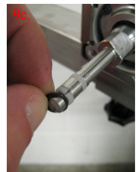
← (izquierda) Eliminar la junta tórica antigua (deteriorada). (derecha) → Colocar la nueva junta tórica por encima del émbolo y delante del anillo blanco.
