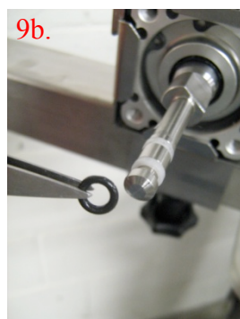
← (izquierda) Eliminar la junta tórica antigua (deteriorada). (derecha) → Colocar la nueva junta tórica por encima del émbolo y delante del anillo blanco.
