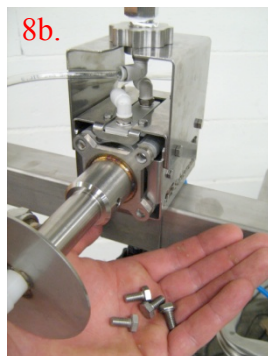
Retirar la carcasa del émbolo al completo junto con el depósito del Oral Dispenser.
