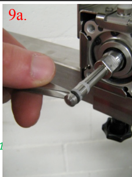
Desenroscar los 4 pernos de la carcasa del émbolo.
