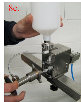
Retirar la carcasa del émbolo al completo junto con el depósito del Oral Dispenser.
