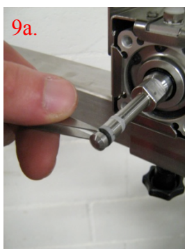
4 Schrauben des Kolbengehäuses lösen.
