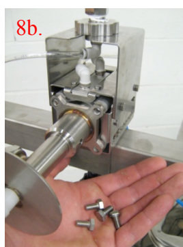
4 Schrauben des Kolbengehäuses lösen.
