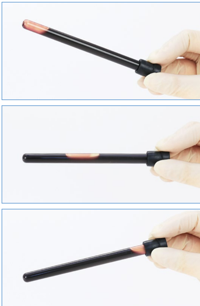
Fig. 20 : La bulle d'air indique que le contenu du tube se mélange effectivement
