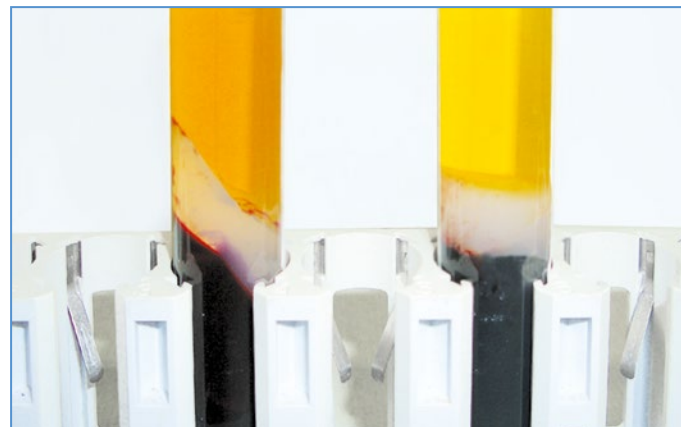
Fig. 27 : A gauche : tube avec gel séparateur centrifugé dans une centrifugeuse à angle fixe. A droite : tube avec gel séparateur centrifugé dans une centrifugeuse « swing-out ».
