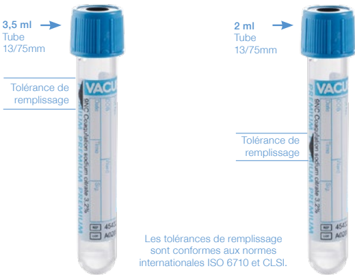
Fig. 19 : Tolérances de remplissage des tubes hémostases
