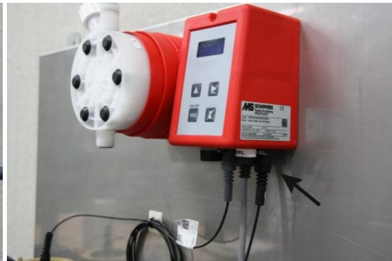
III. 2: Raccorder la sécurité anti assèchement
