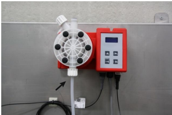
III. 3: Raccorder le tuyau d'arrivée
