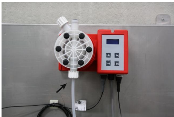
Imagen 3: Conectar tubo flexible aspiración
