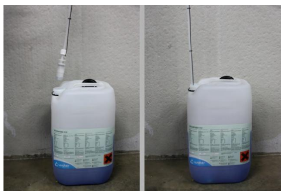
III. 6: Plonger le tuyau d'arrivée dans le réservoir
