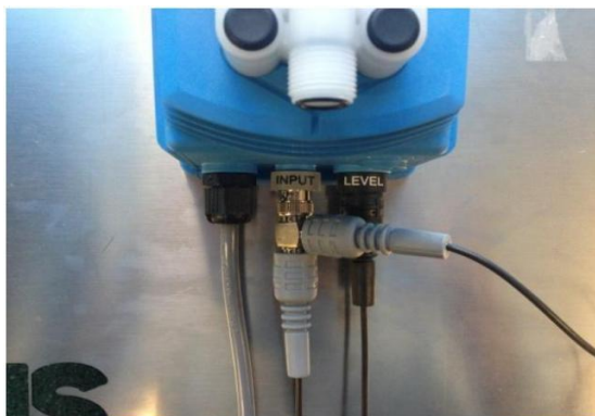
Figur 2: Tilslut tørkøringsbeskyttelsen og vandmåleren.
