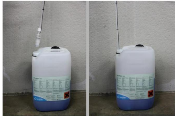
Figur 14: Anbringsugerslangen i væsken
