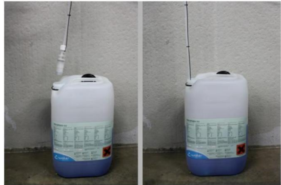
Ill. 14: Plonger le tuyau d'arrivée dans le liquide
