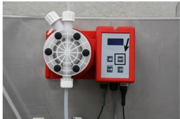
Ill. 16: Remplir la tubulure de sortie
