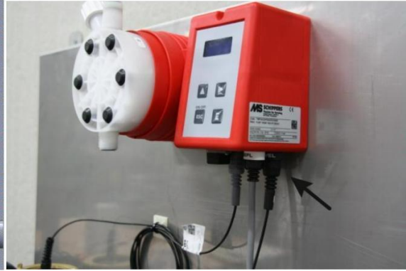
Ill. 6: Raccorder la sécurité anti assèchement
