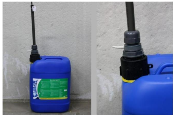
Ill. 10: Placer lance d'arrivée sur le réservoir
