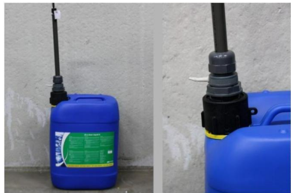
Abbildung 9: Sauglanze mit dem Behälter verbinden
