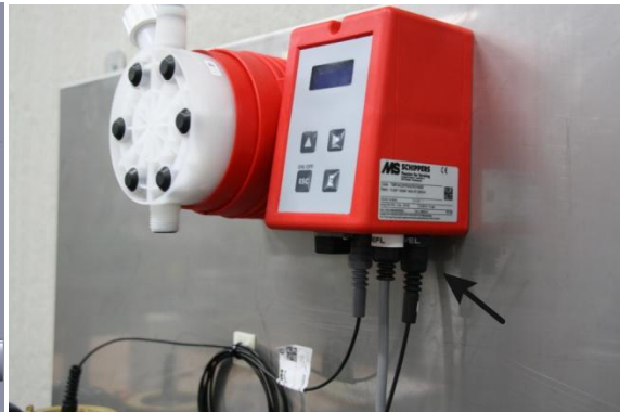
Imagen 6: Conectar protección funcionamiento seco
