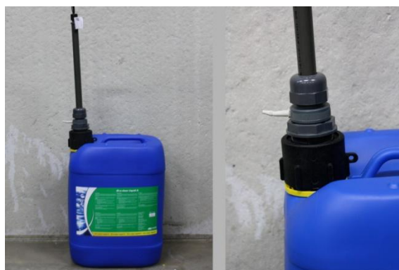
Imagen 10: Colocar lanza de aspiración sobre
