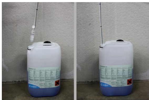
Imagen 14: Colocar el tubo flexible de aspiración en el líquido
