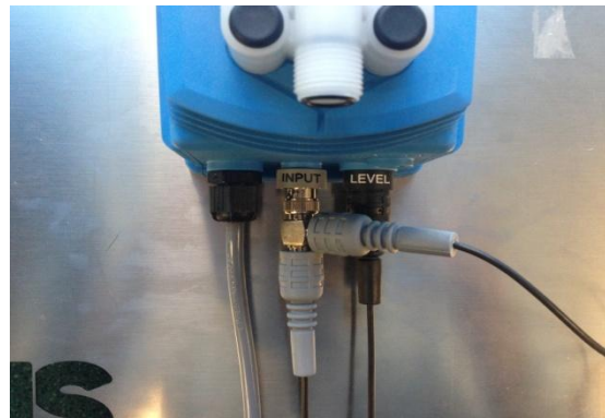
Imagen 2: Conexión de la protección contra el funcionamiento en seco y el contador de agua
