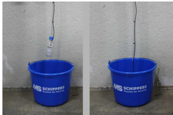
Figura 6: Mettere il tubo di aspirazione nel liquido
