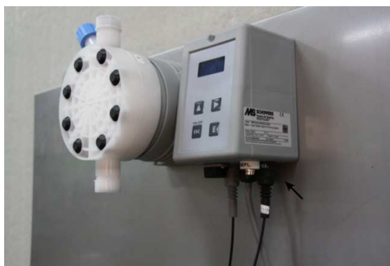
Imagen 2: Conectar protección funcionamiento seco
