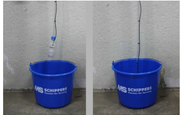
Imagen 6: Colocar el tubo flexible de aspiración en el líquido
