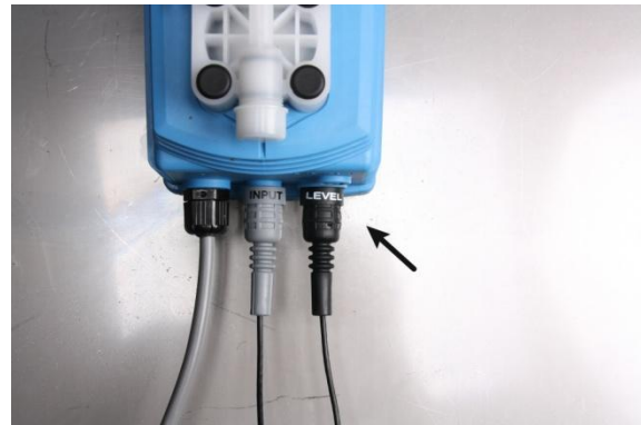
Afbeelding 2: Aansluiten droogloopbeveiliging en waterteller
