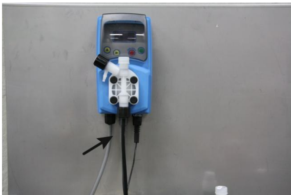
Imagen 3: Conectar tubo flexible aspiración
