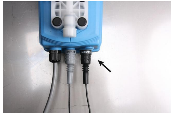
Imagen 2: Conectar protección funcionamiento seco
