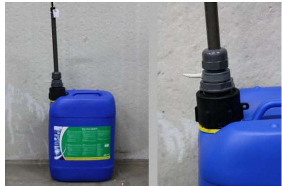
Imagen 6: Colocar lanza de aspiración sobre bidón
