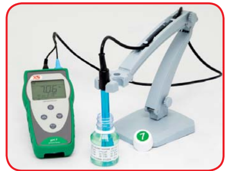
Elektrode houder te gebruiken voor benchmeter (optie)
