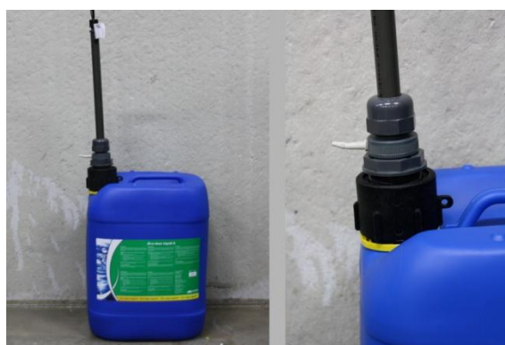
Figura 6: Sistemare il tubo di aspirazione sul bidone
