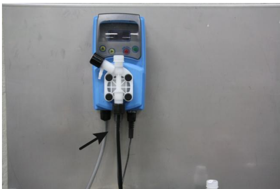
Figura 3: Collegare il tubo di aspirazione
