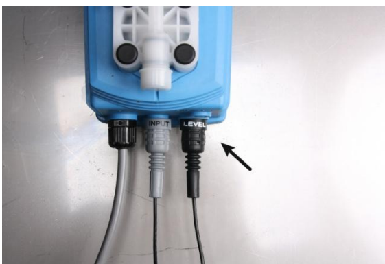
Imagen 2: Conectar protección funcionamiento seco
