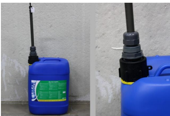
Imagen 6: Colocar lanza de aspiración sobre bidón
