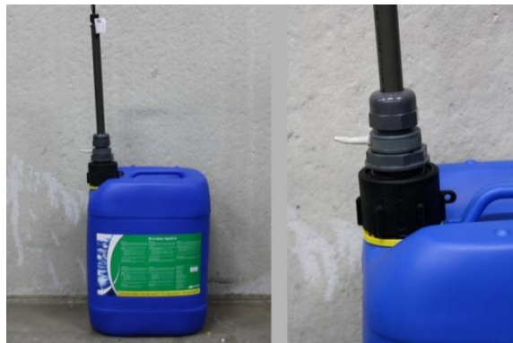
Abbildung 6: Sauglanze mit dem Behälter verbinden
