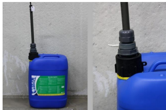
Afbeelding 6: Aanzuiglans op het vat plaatsen
