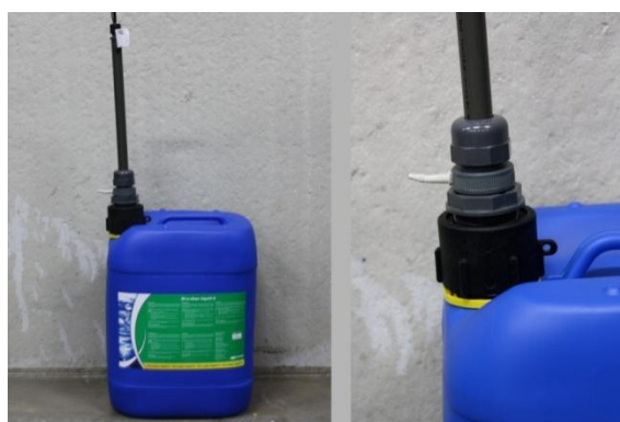
Imagen 6: Colocar lanza de aspiración sobre bidón
