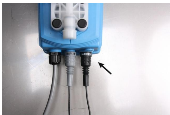
Imagen 2: Conectar protección funcionamiento seco
