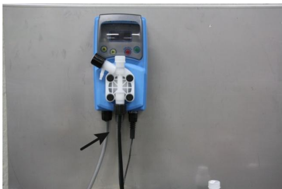
Imagen 3: Conectar tubo flexible aspiración
