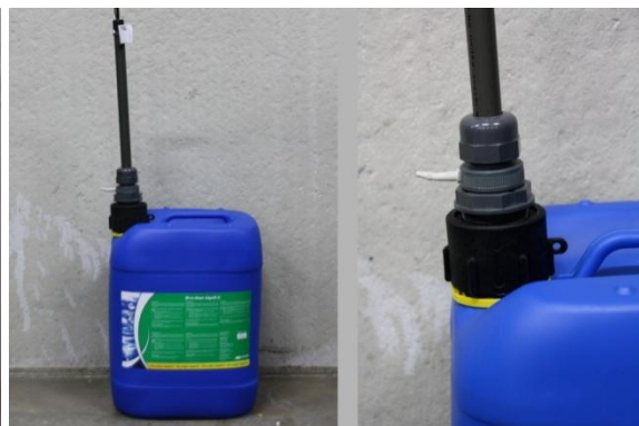
III. 6: Placer lance d'arrivée sur le réservoir
