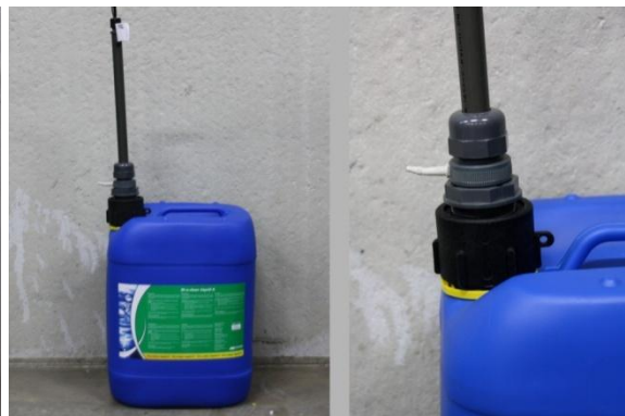
III. 6: Placer lance d'arrivée sur le réservoir
