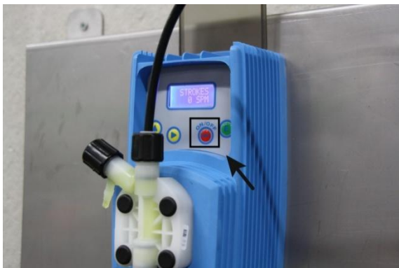
III. 5: Mettre la pompe sous tension
