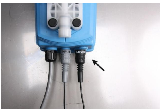
III. 2: Raccorder la sécurité anti assèchement
