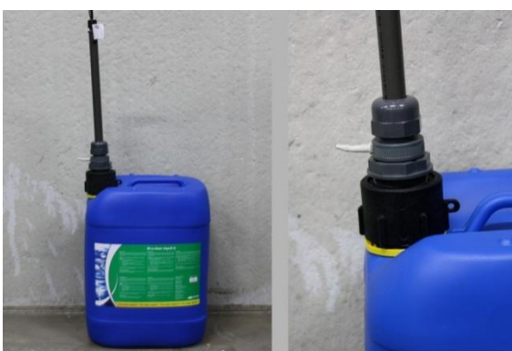
Imagen 6: Colocar lanza de aspiración sobre bidón
