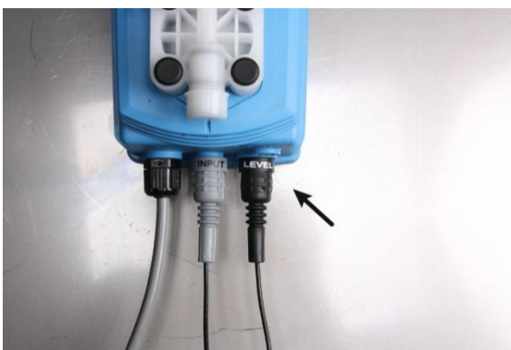
Imagen 2: Conectar protección funcionamiento seco
