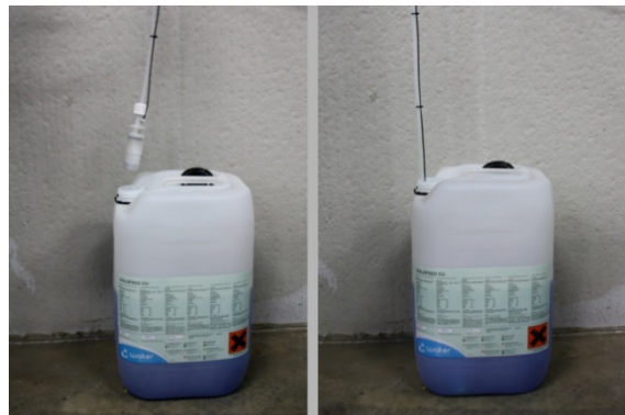
III. 6: Plonger tuyau d'arrivée dans le réservoir
