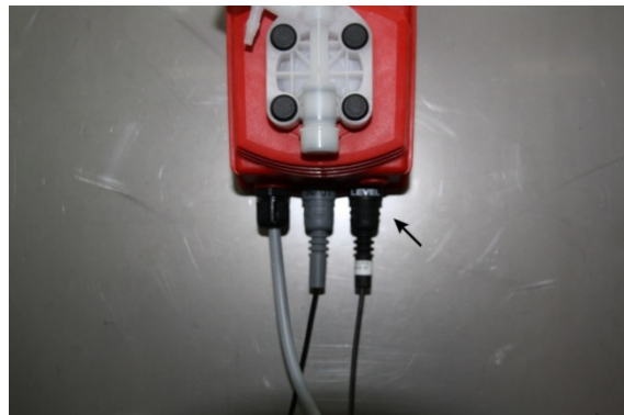
III. 2: Raccorder la sécurité anti assèchement
