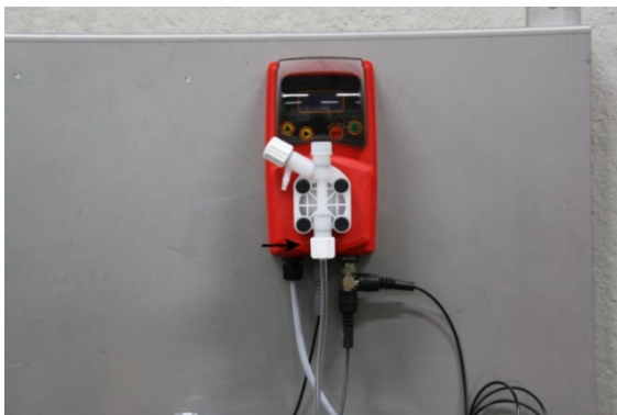
III. 3: Raccorder le tuyau d'arrivée
