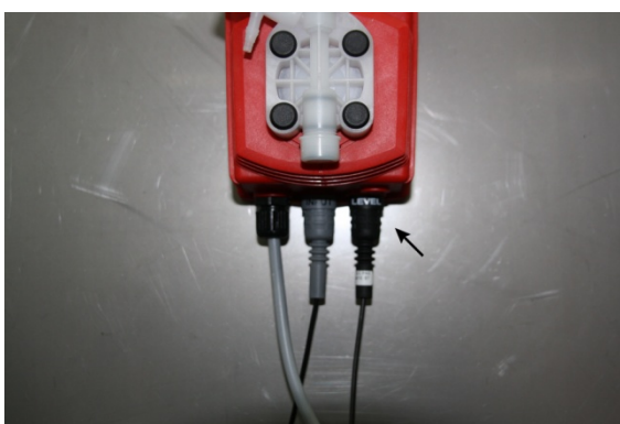
Imagen 2: Conectar protección funcionamiento
