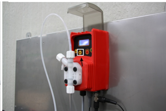
Imagen 8: Llenar el conducto de presión
