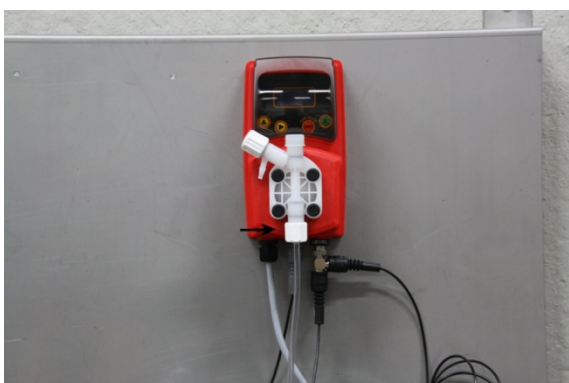
Imagen 3: Conectar tubo flexible aspiración
