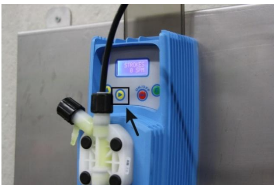
III. 11: Remplir la tubulure de sortie
