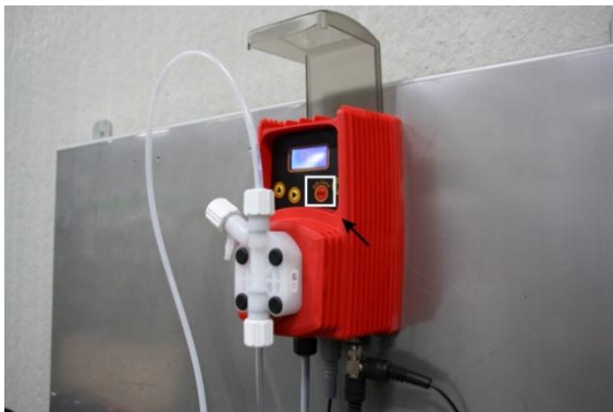
III. 12: Mettre la pompe sous tension
