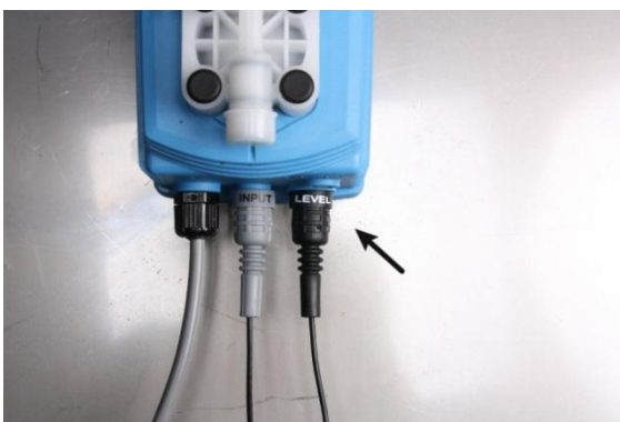
III. 2: Raccorder la sécurité anti assèchement
