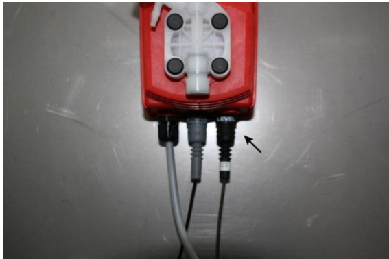
III. 5: Raccorder la sécurité anti assèchement
