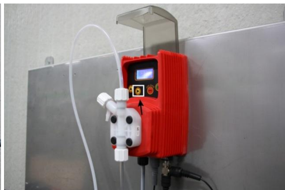
III. 15: Remplir la tubulure de sortie
