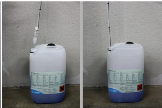
III. 13: placer lance d'arrivée dans le liquide
