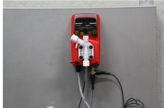
Figura 6: Collegare il tubo di aspirazione
