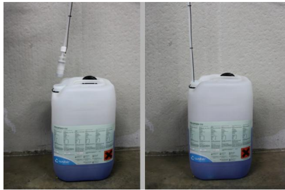
Figura 13: Mettere il tubo di aspirazione nel liquido
