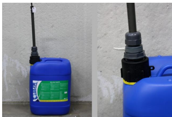
Figura 9: Sistemare il tubo di aspirazione sul bidone
