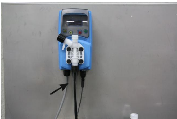
Figura 3: Collegare il tubo di aspirazione
