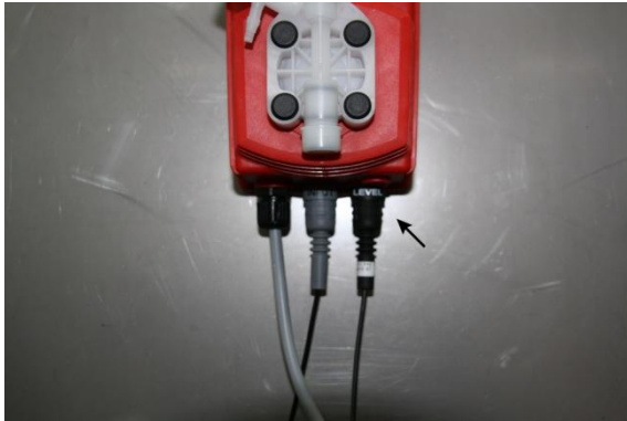
Imagen 5: Conectar protección funcionamiento seco
