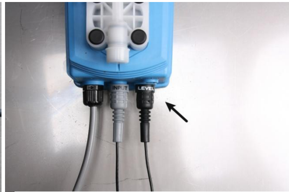
Imagen 2: Conectar protección funcionamiento en seco
