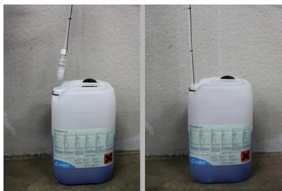
Imagen 13: Colocar el tubo flexible de aspiración en el líquido
