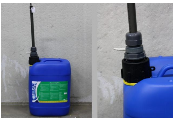
Imagen 9: Colocar lanza de aspiración sobre bidón
