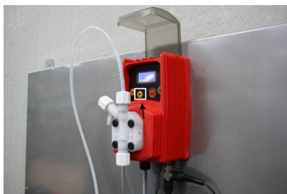
Imagen 15: Llenar el conducto de presión
