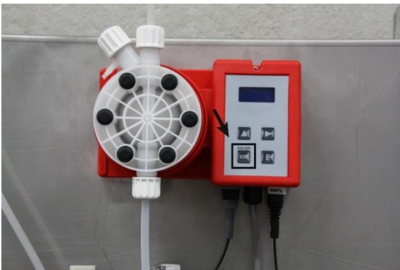
III. 12: Mettre la pompe sous tension
