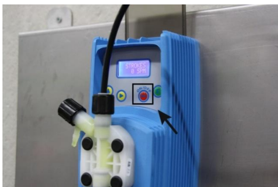
III. 8: Mettre la pompe sous tension
