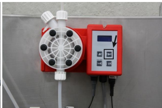
III. 15: Remplir la tubulure de sortie
