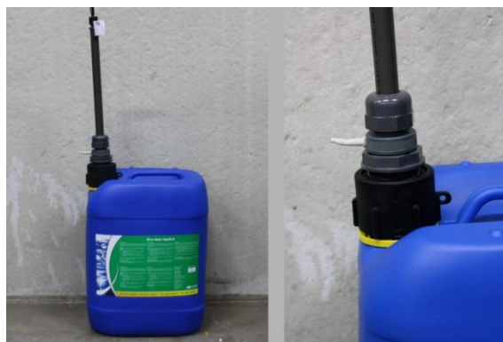
Afbeelding 9: Aanzuiglans op het vat plaatsen
