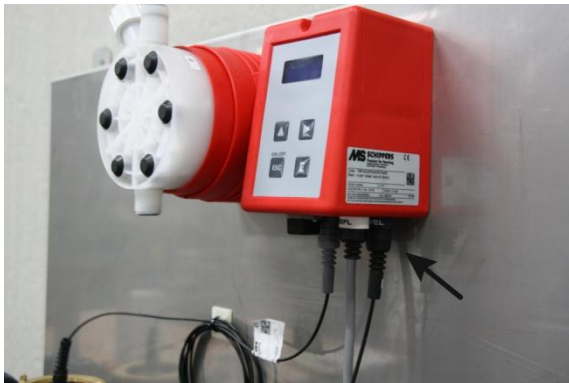
Imagen 5: Conectar protección funcionamiento seco
