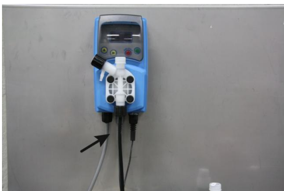
Imagen 3: Conectar tubo flexible aspiración
