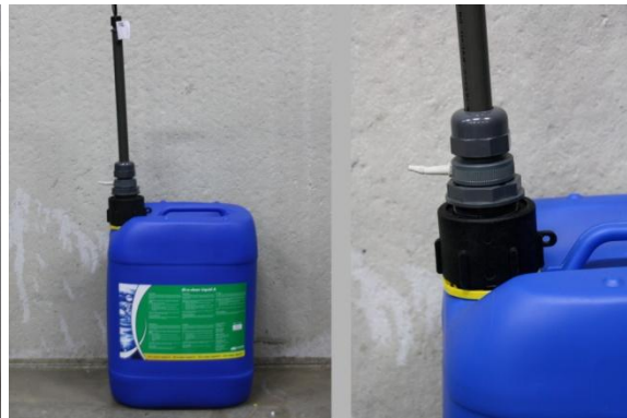
Imagen 9: Colocar lanza de aspiración sobre bidón
