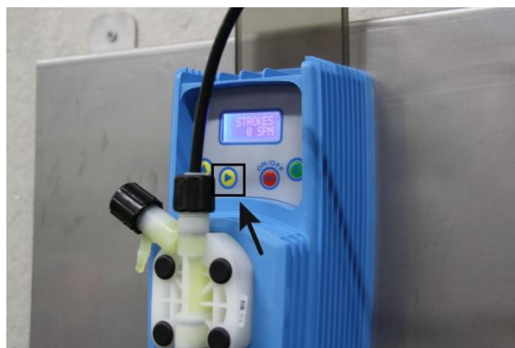
Figura 11: Riempire il condotto in pressione
