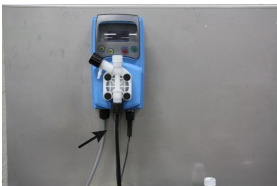
Figura 3: Collegare il tubo di aspirazione
