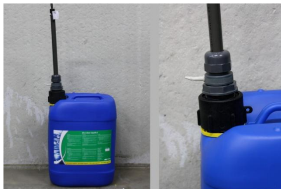
Figura 9: Sistemare il tubo di aspirazione sul
