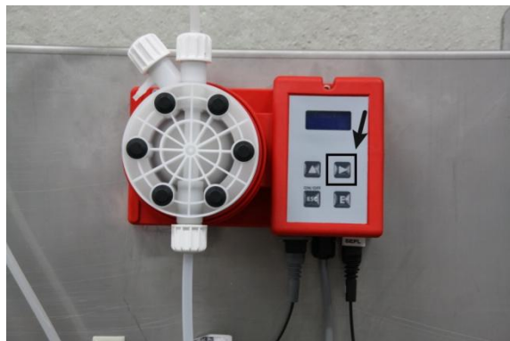
Figura 15: Riempire il condotto in pressione
