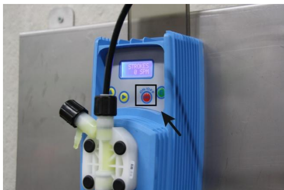
Figur 8: Tænd for pumpen
