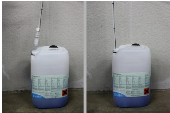
Figur 13: Anbring sugeslangen i væsken
