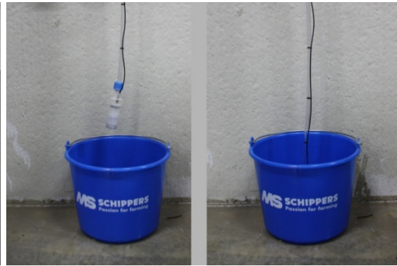
Abbildung 8: Saugschlauch in die Flüssigkeit hängen
