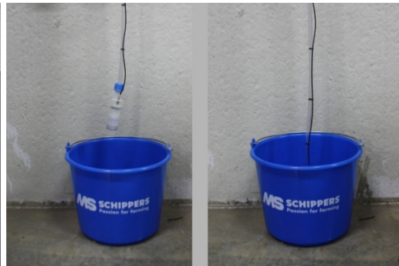
Figur 8: Anbring sugeslangen i væsken
