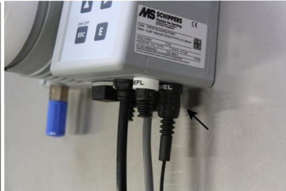
III. 4: Raccorder la sécurité anti assèchement
