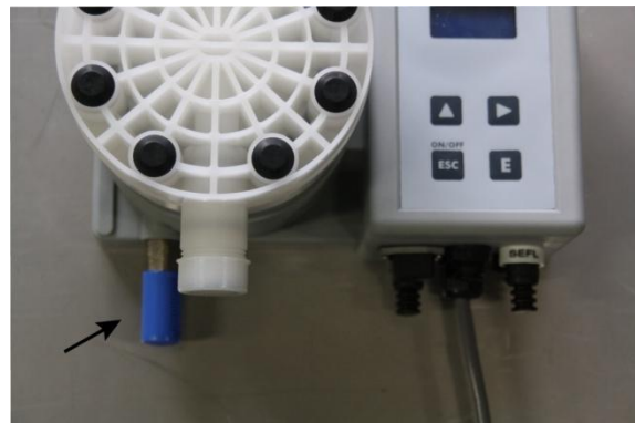
Afbeelding 2: Plaats de geluidsdemper
