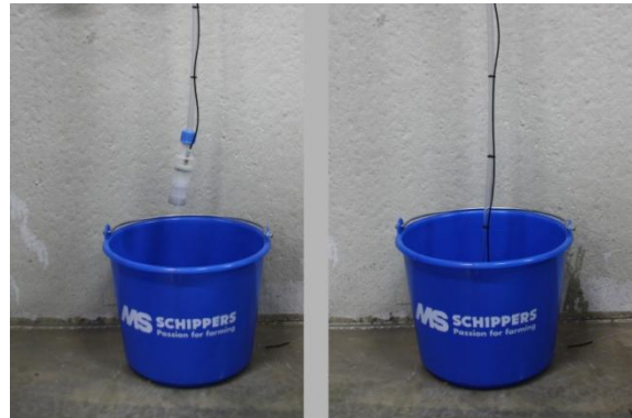
Afbeelding 8: Aanzuigslang in de vloeistof plaatsen
