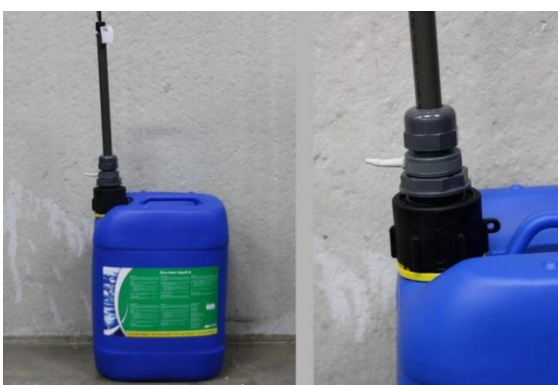
III. 6: Placer lance d'arrivée sur le réservoir
