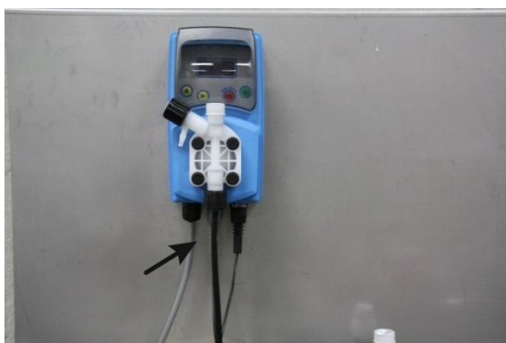
III. 3: Raccorder le tuyau d'arrivée
