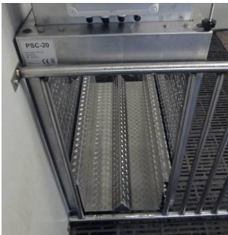
Un astucieux passage entre logettes qui ne touche pas à la construction de la cloison
