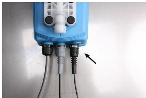
Ill. 2 : Connexion de la sécurité anti-assèchement
