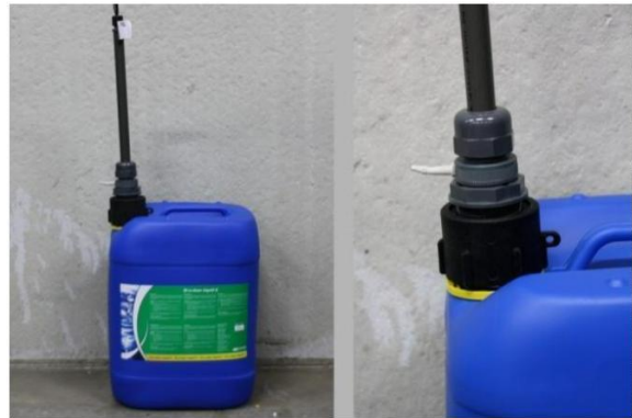
Ill. 6: Placer lance d'arrivée sur le réservoir
